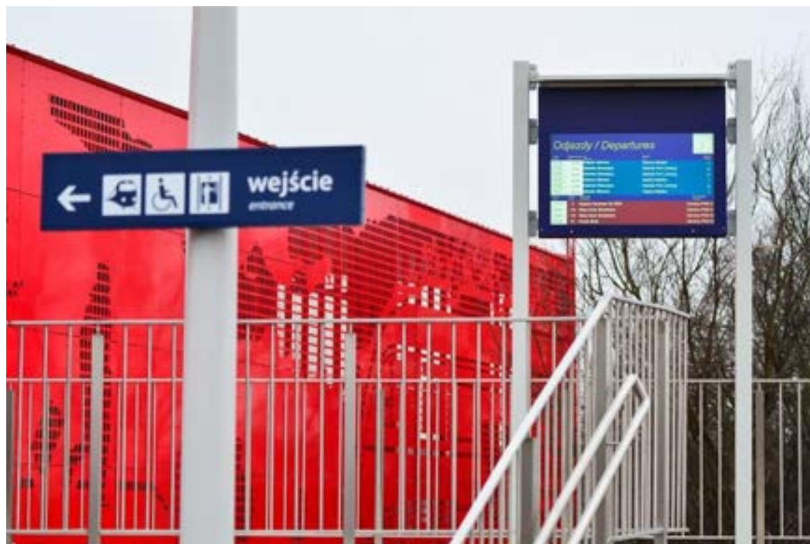
Zdjęcie 4. Wyświetlacz zintegrowanej informacji pasażerskiej na przystanku PKM Gdynia Karwiny - widoczne odjazdy pociągów i autobusów miejskich
