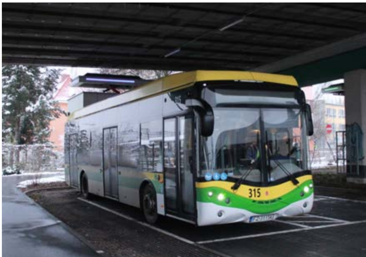
Rysunek 11. Autobus elektryczny MZK Zielona Góra korzystający ze stanowiska ładowania
